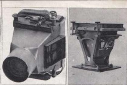
Hierboven links: detailopname van een overboord-camera. Rechts: een inbouwcamera voor loodrechte opnamen met 25 c.m. objectief.
