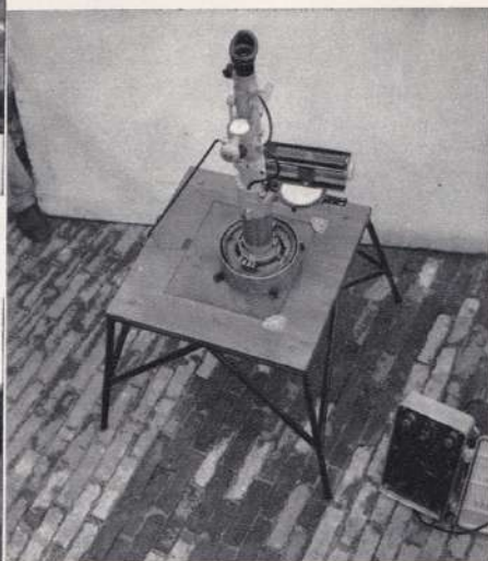
De bommenrichtkijker met bommenafwerpkastje welke in de waanmercockpit aanwezig zijn bij het uitvoeren van een luchtbombardement. Links: inschietschijf geplaatst voor het schroefvlakschieten van de vliegtuig-mitrailleur.
